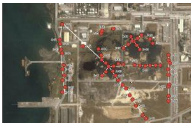
Gambar 2. Sebaran Lintasan Pengukuran Geolistrik yang Melintasi Lahan Terkontaminasi Limbah B3 Berupa Acid sludge (Lintasan Ditandai dengan Titik-Titik Berwarna Merah)
